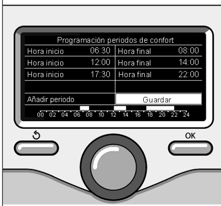
Programar períodos confort programación horaria calefacción
